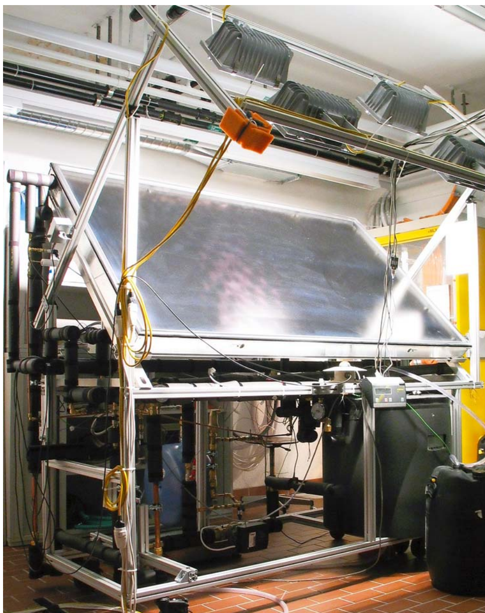
Die Versuchsanlage an der ETH Zürich besteht aus einem umgebauten Solarkollektor. Sie verfügt über einen Tank von 140 Litern für das Wasser-Glykol-Gemisch. (Foto: Eismann-Fry)
