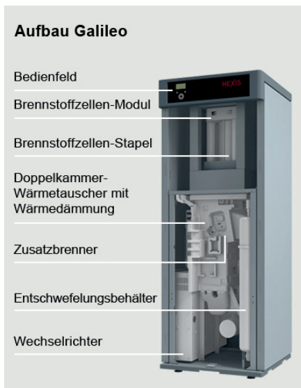
Die Komponenten des Brennstoffzellen-Heizgeräts von Hexis sind in einem 164 cm hohen, 62 cm breiten und 58 cm tiefen Gehäuse untergebracht. Das Gerät wiegt 170 kg.
