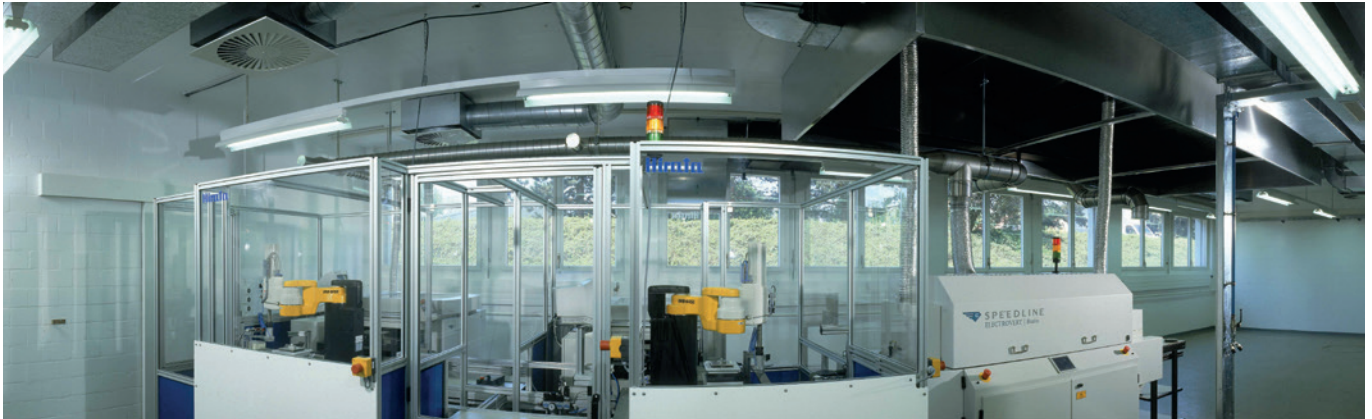
Brennstoffzellen werden in einem teilautomatischen Fertigungsprozess hergestellt, damit die keramischen Bauteile keine Qualitätsschwankungen haben.
