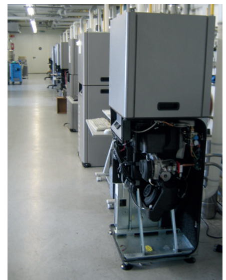
Im Labor in Oberwinterthur testet Hexis seine Brennstoffzellen-Heizgeräte über mehrere Jahre, um die Langlebigkeit der darin verbauten Brennstoffzellen zu untersuchen.
