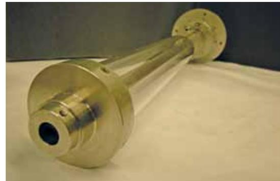
*Der Bau eines Brenners zur Verbrennung von Wasserstoff war für die Forscher der FHNW eine Herausforderung. Bei der Konstruktion mussten sie den Umstand berücksichtigen, dass sich Quarzglas unter Hitzeeinfluss praktisch nicht ausdehnt, die Metallteile hingegen schon.*
