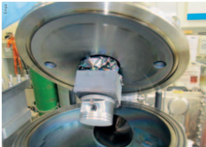
An der Empa wurden die Kolben durch den im Vakuum ausgeführten Sputtering-Prozess mit Platin beschichtet.
