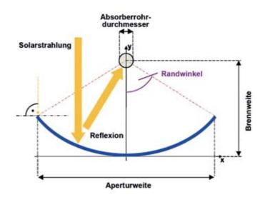
Je exakter die Parabolform erreicht wird und je weniger Hindernisse für die Einstrahlung und Reflexion der Sonne vorhanden sind, umso höher wird der Wirkungsgrad.
