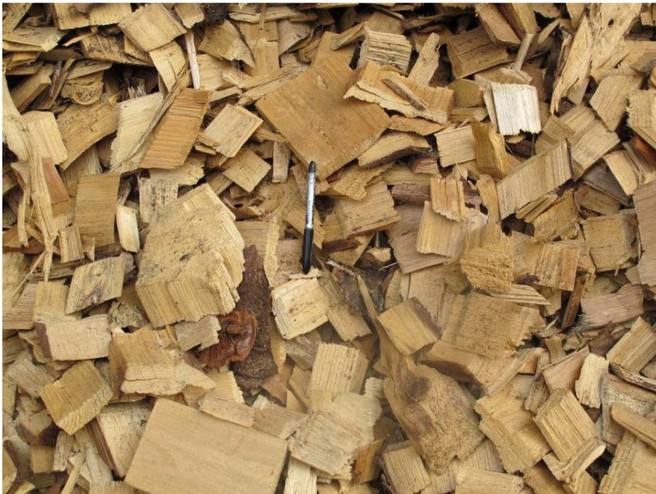
*Figur 17: Erforderliche Schnitzelqualität für den Holzvergaser Urbas GmbH. Ideal wäre eine Schnitzelgröße von 100 x 100 x 100 mm.*
