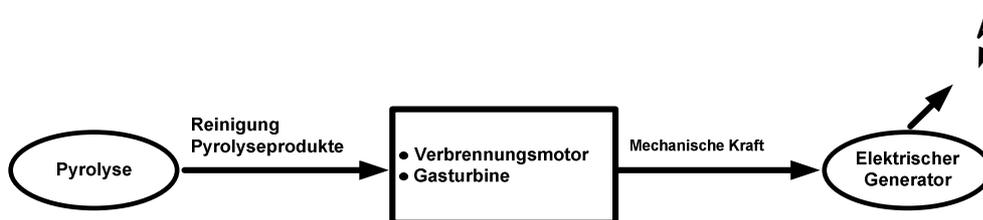
Figur 6: Funktionsprinzip Pyrolyse
