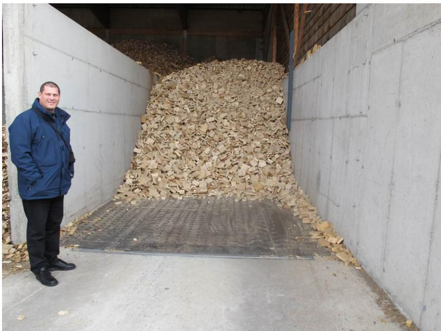
*Figur 19: Schnitzeltrocknung (Einblasen von warmer Luft von unten).*
