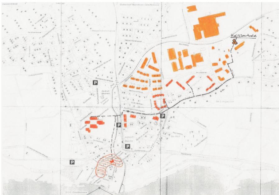
Figur 28: Wärmeverbund Greifensee ZH: Orange = bestehendes Wärmenetz, rot = möglicher Ausbau
