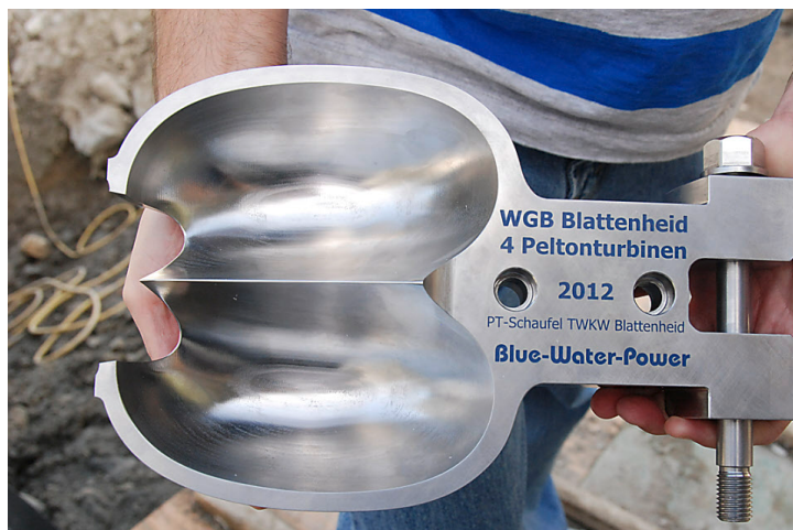
21 Schaufelräder dieser Grösse sind am Turbinenrad angebracht. Dieses treibt den Generator an, welcher auf der Alp Blattenheid Strom erzeugt.
