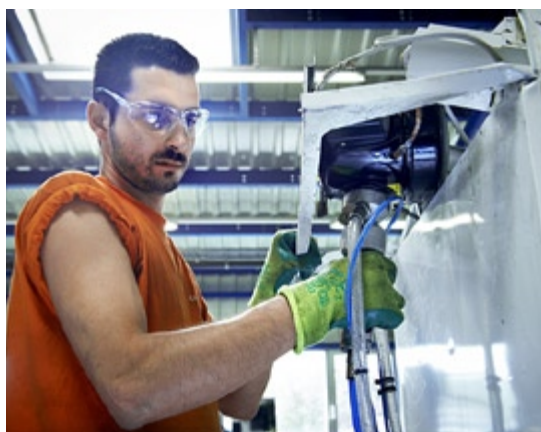
Das Kältemittel wird zu 100 Prozent abgepumpt und verbrannt.
