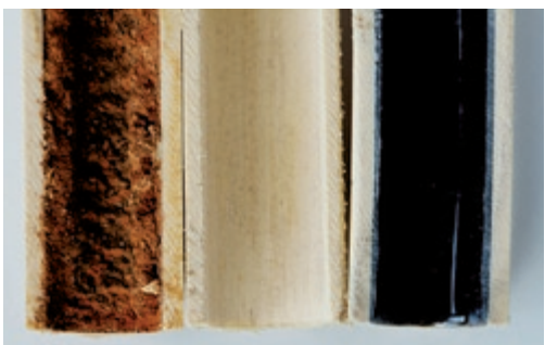
Heizrohr: vor, während und nach der Sanierung.
