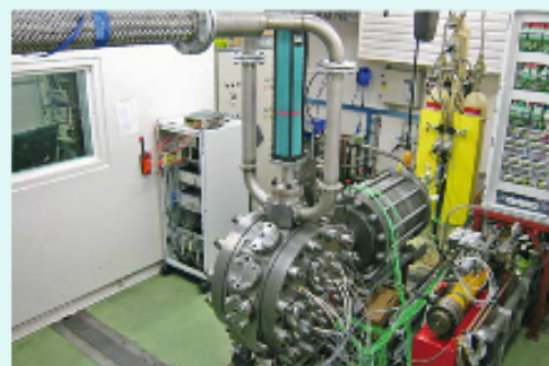
Mit Unterstützung des BFE konnten die ETH, das PSI und der Industriepartner Wärsilä in Oberwinterthur eine Testanlage für Einspritz- und Zündvorgänge bei Schiffsdieselmotoren realisieren. (Bild: ETHZ/Wärsilä)
