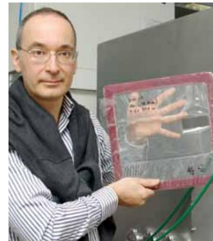
Dr. Frank Nüesch zeigt im Empa-Labor zur Entwicklung von Farbstoff-Solarzellen die Folie mit integrierten Gewebeelektroden.
