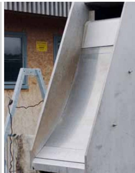
Das Bogensieb wird zu Beginn für die Fest-Flüssig-Trennung der Gülle verwendet.
