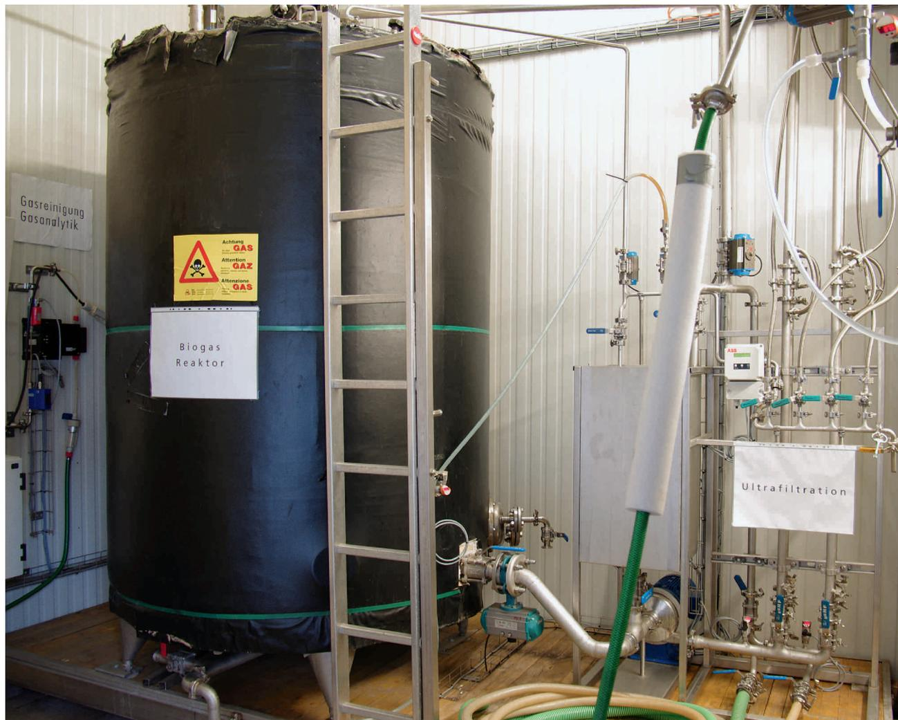
Die Versuchsanlage an der ART in Tänikon umfasst einen Fermenter mit 3000 Liter Inhalt. Die Ultrafiltration findet in diesen Rohren rechts vom Fermenter statt und scheidet die inaktiv gewordenen Bestandteile aus
