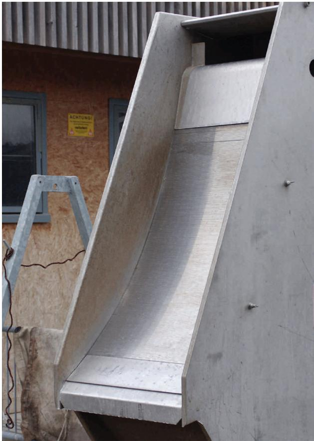
Das Bogensieb wird zu Beginn für die Fest-Flüssig-Trennung der Gülle verwendet
