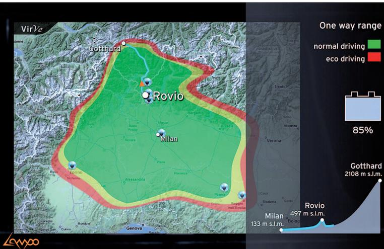
Als Resultat des VEL-Programms hat Protoscar zusammen mit VirVe ein System zur GPS-basierten Reichweitschätzung entwickelt.
