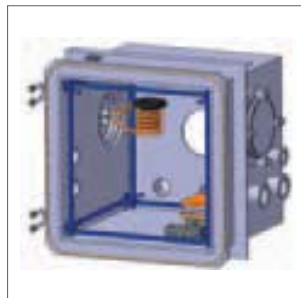
Design der Hochvakuumkammer mit integriertem Schmelztiegel im Rahmen des von der EKZ unterstützten Forschungsprojekts der Empa in Dübendorf.
