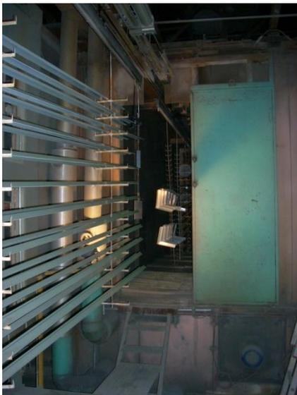
Abbildung 3-7 Haftwassertrockner
