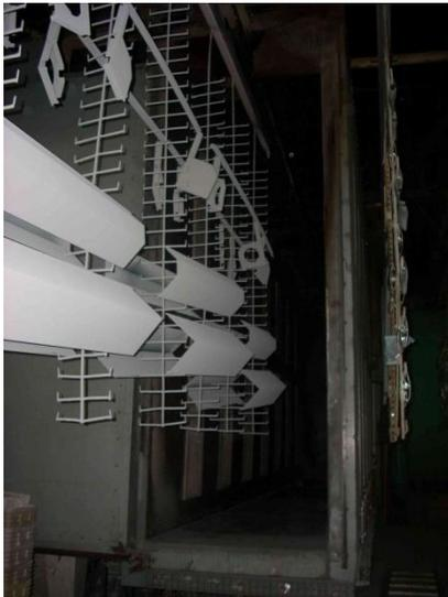
Abbildung 3-13 Einbrennofen
