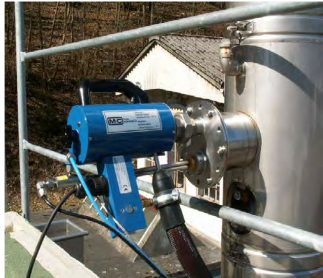
Beheizte Messsonde am EMPA-Messstutzen
