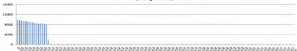
5 Min-Mittelwerte von CO mg/Nm 3 und v>0.3 m/s (Bezug 13% O 2 )
