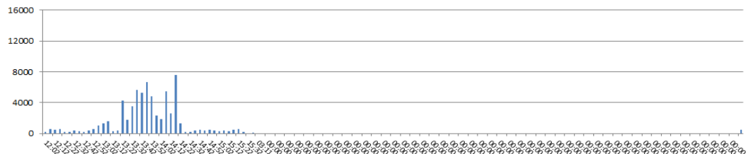
15 Min-Mittelwerte von CO mg/Nm 3 (Bezug 13% O 2 )
