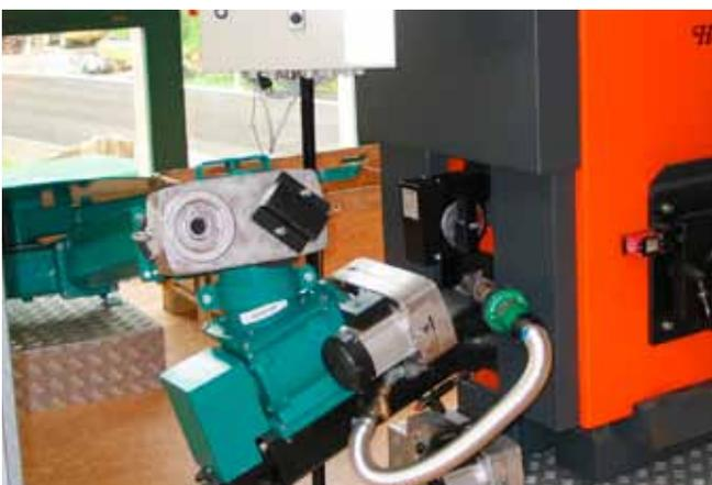
Holzsnitzelkessel (30 kW Leistung) mit Schnitzelzufuhr und Rückbransicherung.
