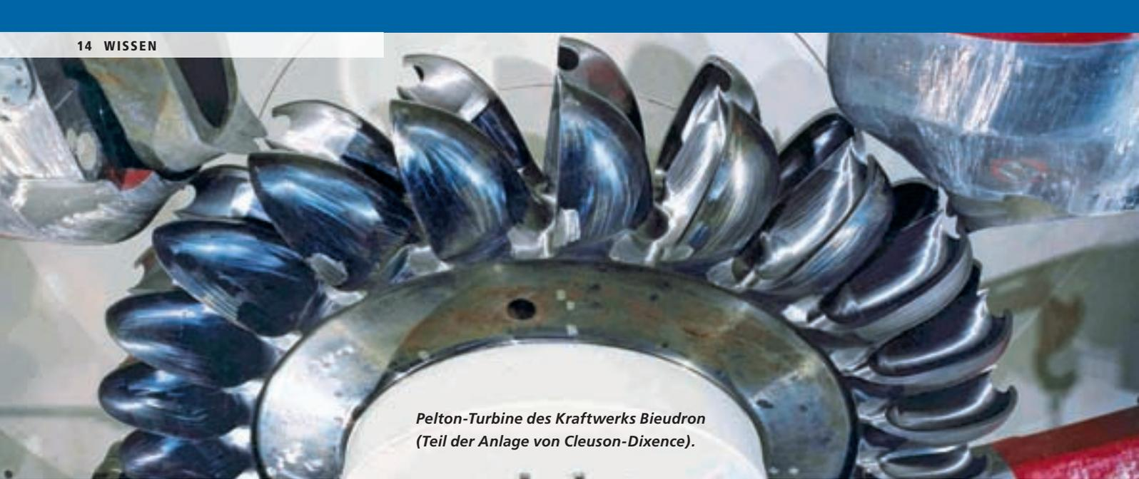
*Pelton-Turbine des Kraftwerks Bieudron
