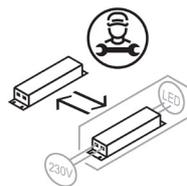
auswechselbares Betriebsgerät durch eine Fachperson (der Hersteller legt fest, wer dazu qualifiziert ist)
