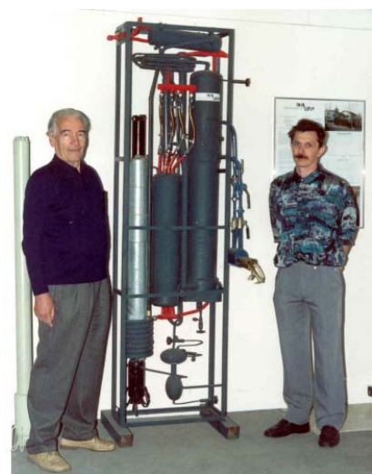
Bild 8: Diffusions-Absorptions-Wärmepumpe der Firma Creatherm.
