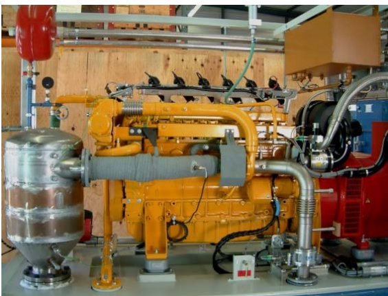
Bild 9: AGR-SwissMotor der Firma Liebherr in einem BHKW der Firma DIMAG. (Bild: DIMAG)
