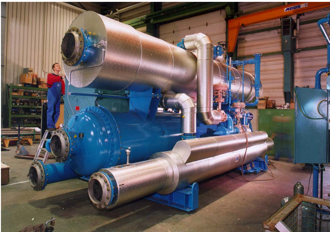
Bild 7: Werkmontage bei AXIMA Refrigeration GmbH in Lindau (D) Rückseite der Wärmepumpe.
