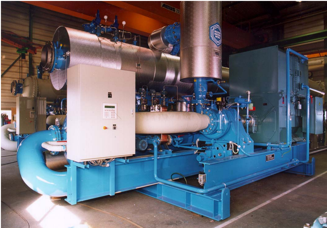
Bild 6: Werkmontage bei AXIMA Refrigeration GmbH in Lindau (D) Vorderseite der Wärmepumpe.
