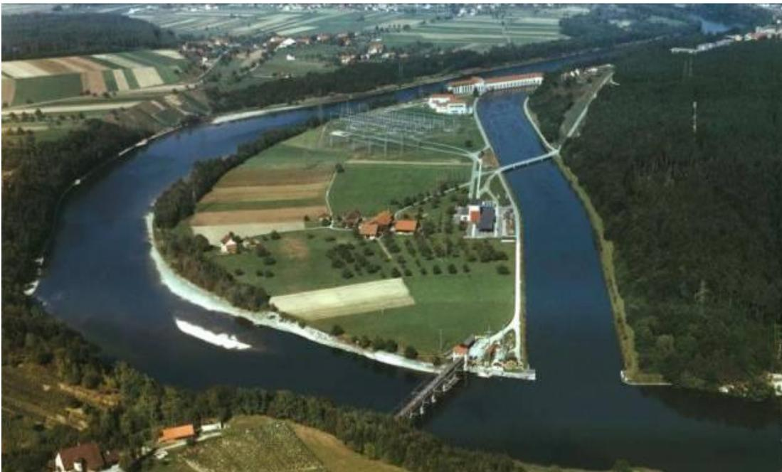
Darstellung 4.9-2: Insel Beznau 1966 während der Bauarbeiten für das Kernkraftwerk. Der Boden wurde grossflächig entfernt, der Uferbereich jedoch belassen. Im Hintergrund die Umspannanlagen und das Wasserkraftwerk mit noch bestehenden Nebengebäuden. Diverse Materialdepots sind ebenfalls zu erkennen.
