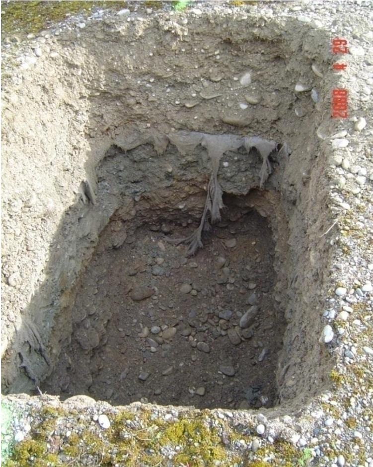
Darstellung 4.10-12: Details der Schicht unter dem Trennflies. Graue Färbung, Durchnässung und hoher Feinanteil erkennbar.
