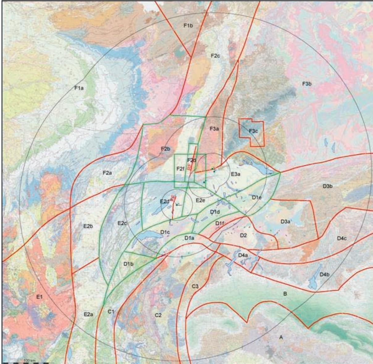
Abbildung 3.6-14 Beispiel der Aufteilung in seismische Flächenquellen und in zwei lineare Störungs-zonen durch die Expertengruppe EG1a. Die seismischen Quellen sind auf dem Hintergrund einer geologischen Karte dargestellt.
