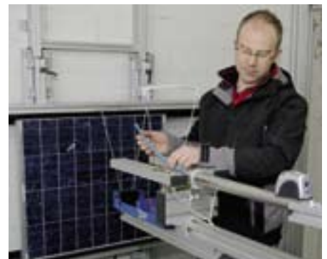
ISAAC-Mitarbeiter Mauro Bernasocchi bedient die Schussvorrichtung für den Hageltest.
