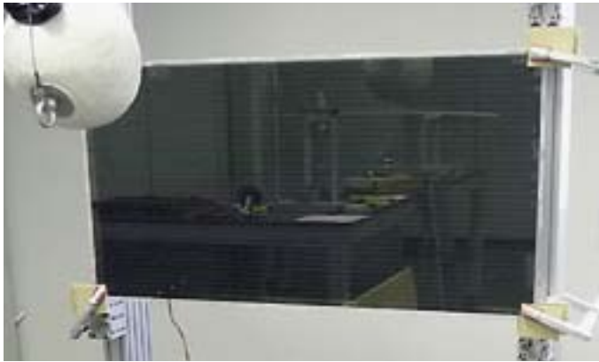
Mit dem Schlagtest auf ein Modul können die Grössen der Glassplitter eruiert werden
