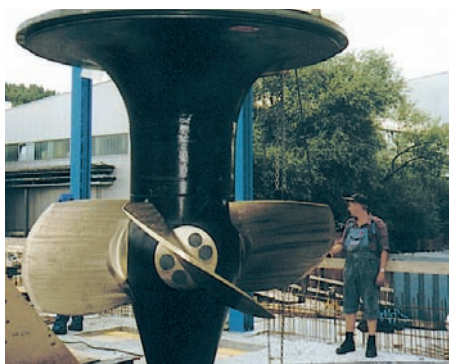
In die Saugrohre wurden Kaplan-turbinen eingesetzt. Foto: ITECO AG
