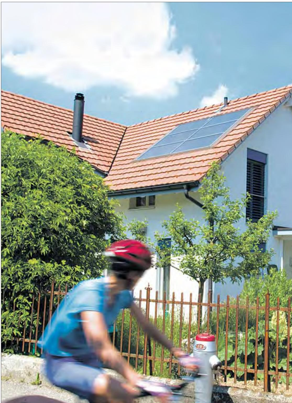
Vier bis sechs Quadratmeter Sonnenkollektoren auf dem Dach decken bis zu 70 Prozent des Warmwasserverbrauchs einer vierköpfigen Familie. (Fotos: Swissolar)
