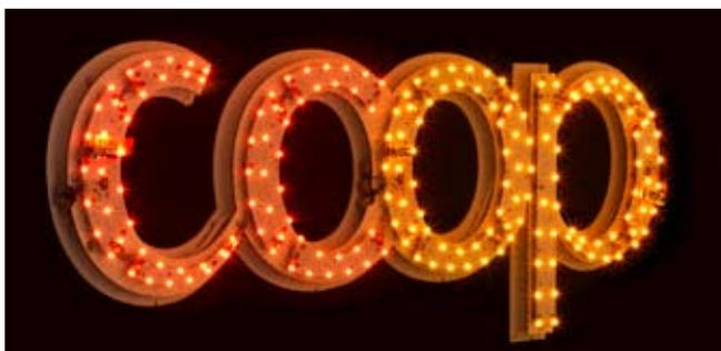
Der grosse Spareffekt der neuen Leuchtschriften entsteht in Kombination mit der dazu entwickelten intelligenten elektronischen Steuerung. Diese passt die Leuchtwerbeanlagen dem Umgebungslicht an. Daneben wird auch dem Artenschutz Rechnung getragen: Die LED arbeiten mit für nachtaktive Insekten unschädlichen Wellenlängen und Farbspektren.
