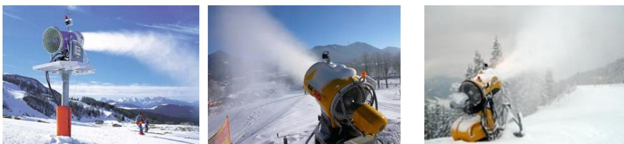
Abb. 1 bis 3: Niederdrucksystem fix auf Masten und auf mobil auf Schlitten montiert
