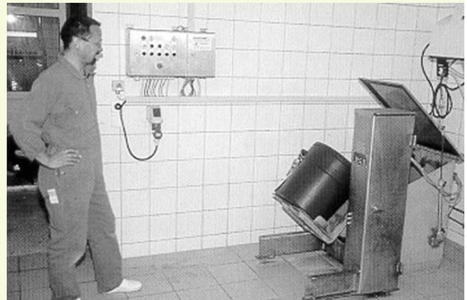
*Speiseabfälle werden mittels automatischer Kippvorrichtung in den Annahmetrichter entleert.*
