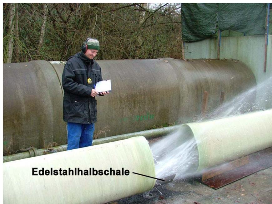
Die Abbildung zeigt die in ein GfK-Rohr eingebaute Edelstahl-Halbschale. Zur Durchführung der 30 Reinigungszyklen unter Zugabe von Prüfgeschiebe wurde die Rohrverbindung zusammenschoben.
