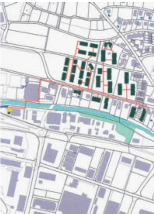
Abb. 3 Das grösste Potenzial zur Energierückgewinnung liegt beim gereinigten Abwasser nach der Kläranlage. Im Bild die schematische Darstellung des Abwasserwärmeverbundes Sissach AG.
