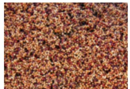
Abb. 4 Trägerkörper (2–4 mm).
