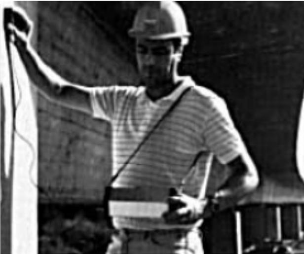
Bild 5.15 Zerstörungsfreie Messung der Betonüberdeckung der Bewehrung
