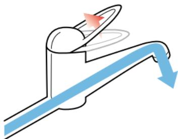
Beim Öffnen des Warmwasserhahns zum Händewaschen fließt aus der Warmwasserleitung zunächst kaltes Wasser.
