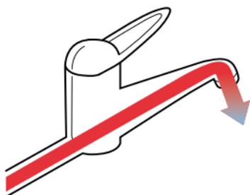
Bis das nachfließende Warmwasser Sie erreicht, sind Ihre Hände bereits sauber. Das aufgeheizte Warmwasser kühlt ungebraucht in der Warmwasserleitung wieder ab.
