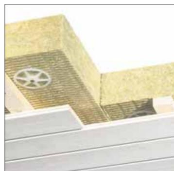
Für die Befestigung der Abdeckung werden zuerst Latten mit langen Distanzschrauben in der Decke verankert. Im Hohlraum hat es Platz für elektrische Leitungen.
