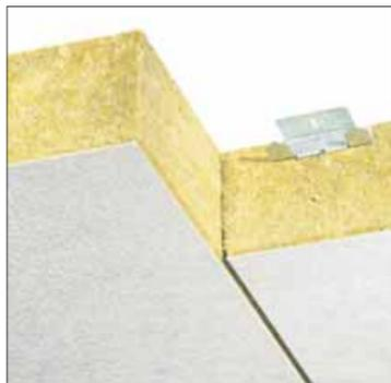
Bei der unsichtbaren Befestigung werden die Dämmplatten mit Haftkrallen an der Decke montiert. Die Steinwollämmplatten sind formstabil und genau zugeschnitten. Das Schneiden von kleineren Randplatten und Aussparungen ist einfach.
