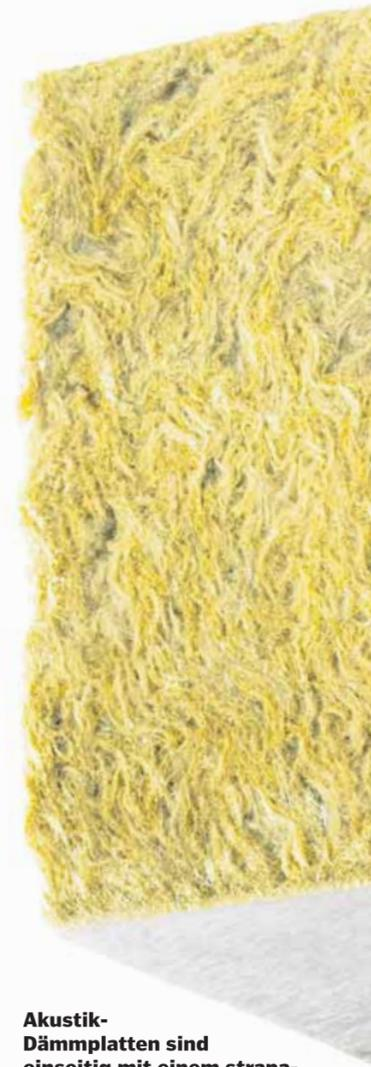
Akustik-Dämmplatten sind einseitig mit einem strapazierfähigen, hellen Glasvlies beschichtet, das optisch wie ein Deckenverputz wirkt. Sie werden direkt an der Betondecke fixiert – entweder mit Haftkrallen oder Dübeln oder mit einem Spezialkleber wie zum Beispiel Silacolle.
