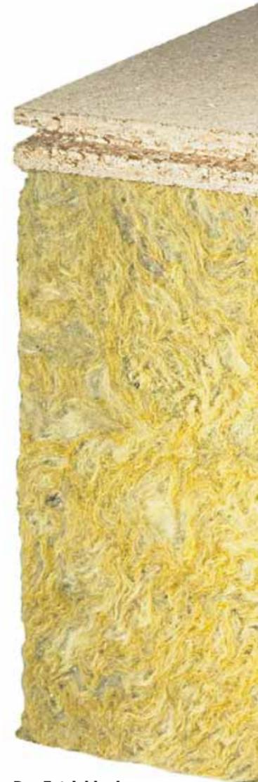
Das Estrichbodenelement besteht aus einer selbsttragenden Steinwollämmplatte, die bündig mit einer Holzspanplatte verklebt ist. Der begehbare Boden wird somit gleichzeitig mit der Dämmung verlegt. Für die einfache Handhabung sind die Dämmplatten auf allen Seiten mit einer Nut versehen.
