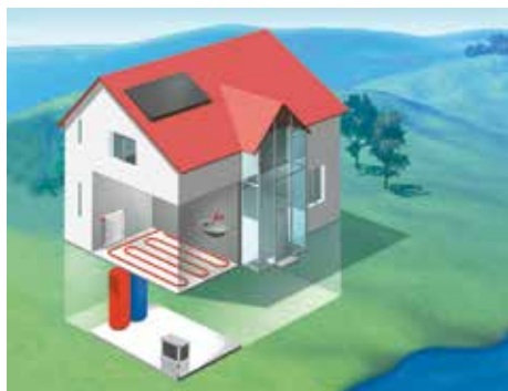
Abbildung 4.2: Kompakt-Anlage für Innenaufstellung (Bild: BKW AG).
