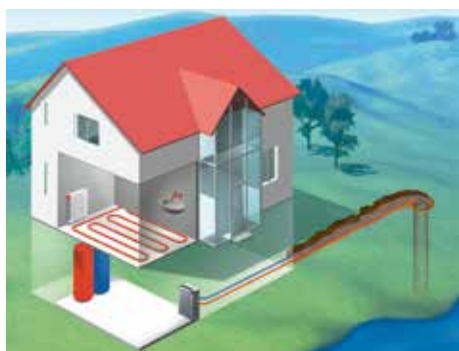
Abbildung 4.4: Erdwärmesonde (Bild: BKW AG).
