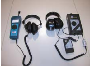
Abb. 5: Ultraschallortungsgeräte für das Aufspüren von Leckagen
