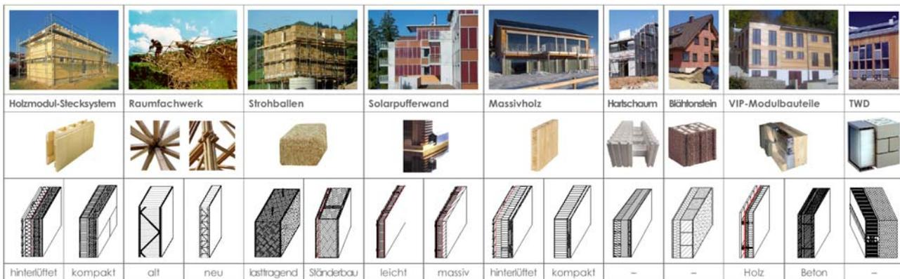
Fig. 2: Übersicht aller untersuchten Konstruktionen. Quelle: AEU GmbH (CH)
