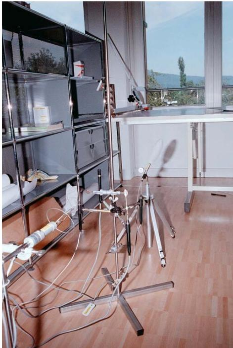
Abbildung 5: Messaufbau zur Bestimmung der Behaglichkeit und des thermischen Komforts.
