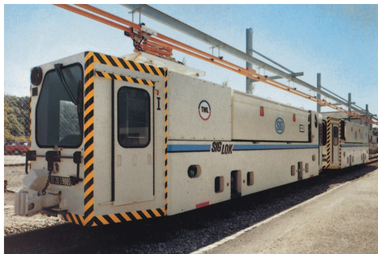
Fig. 5.5 Beispiel einer im Verbund arbeitenden Stollenlokomotive wie sie z.B. beim Bau des Eurotunnels (Ärmelkanal) im Einsatz war
