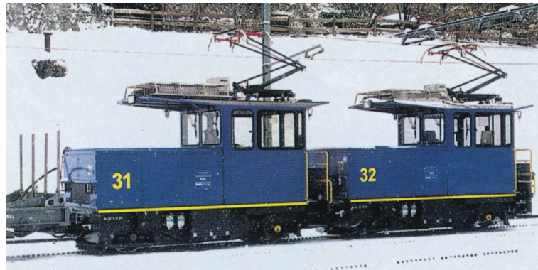
Fig. 5.4 Beispiel einer Zahnradlokomotive – Lokkonfiguration HGea 2/2 in Doppeltraktion
