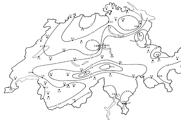
Abb. 4: Durchschnittliche, jährliche globale Einstrahlung auf eine horizontale Fläche in der Schweiz
