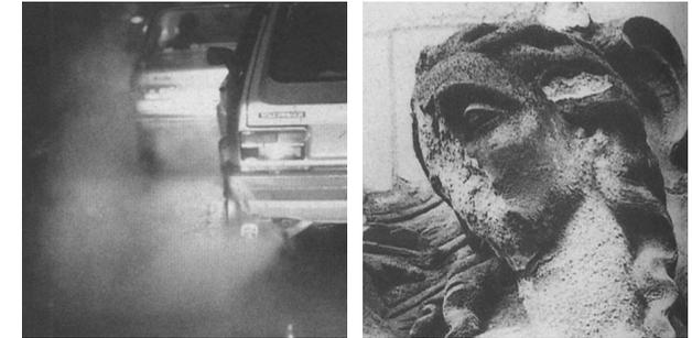
Abb.11 Korrosion durch Luftschadstoffe
