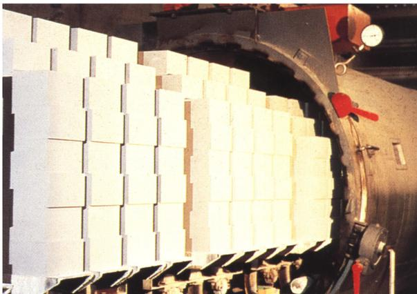
Abb.10 Kalksandsteinherstellung im Autoklav
