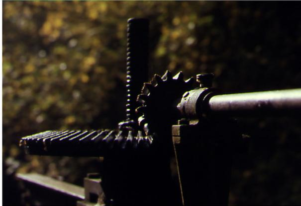
Abb. 13 Kleinstwasserkraftwerk, Antriebswelle
