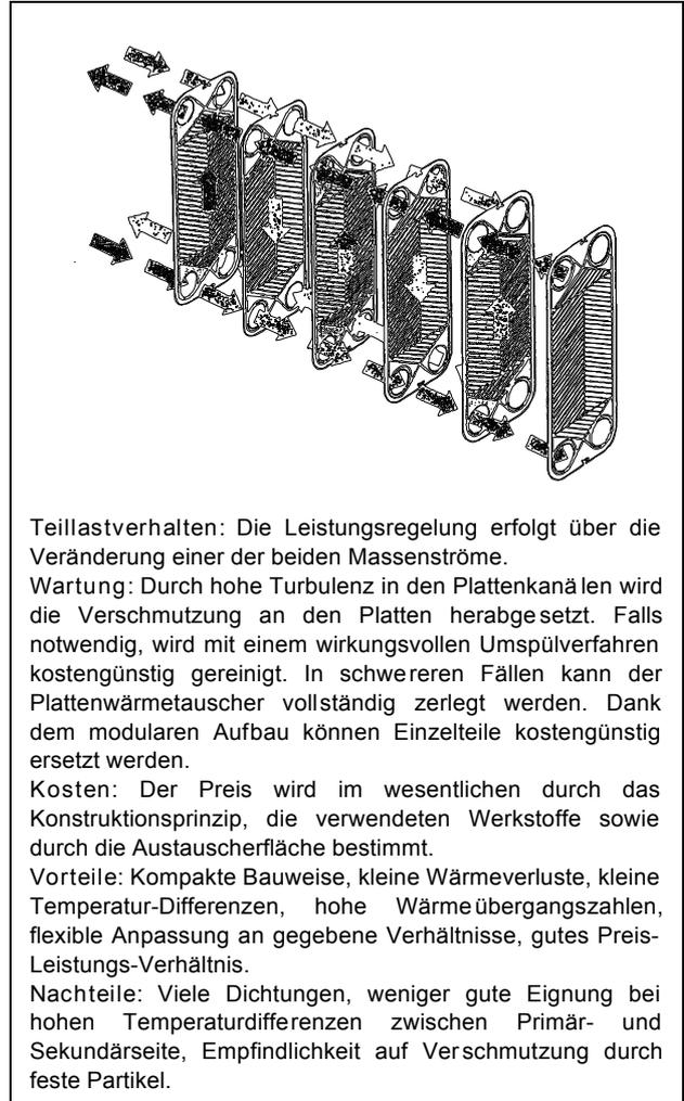
Bild 8: Plattenwärmetauscher für Flüssigkeiten
