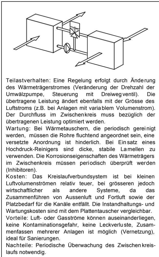
Teilastverhalten: Eine Regelung erfolgt durch Änderung des Wärmeträgerstromes (Veränderung der Drehzahl der Umwälzpumpe, Steuerung mit Dreiwegventil). Die übertragene Leistung ändert ebenfalls mit der Grösse des Luftstroms (z.B. bei Anlagen mit variablem Volumenstrom). Der Durchfluss im Zwischenkreis muss bezüglich der übertragenen Leistung optimiert werden.
