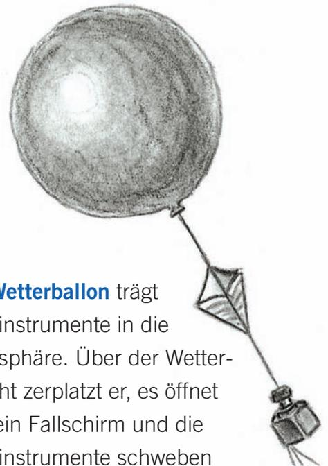
Der **Wetterballon** trägt Messinstrumente in die Atmosphäre. Über der Weterschicht zerplatzt er, es öffnet sich ein Fallschirm und die Messinstrumente schweben zurück auf die Erde.
