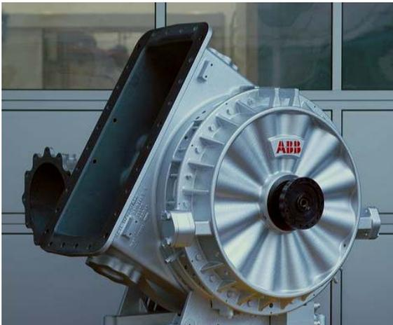
**ABBILDUNG 2:** NUTZTURBINE AUF BASIS TURBOLADER VON ABB
