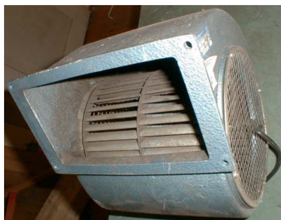
c) Radialventilator mit vorwärts gekrümmten Schaufeln ("Trommelläufer")
