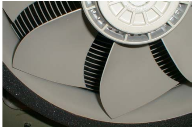
a) Axialventilator mit sichelförmigen Schaufeln und steilem Schaufelwinkel
