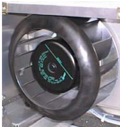
b) Radialventilator mit rückwärts gekrümmten Schaufeln
