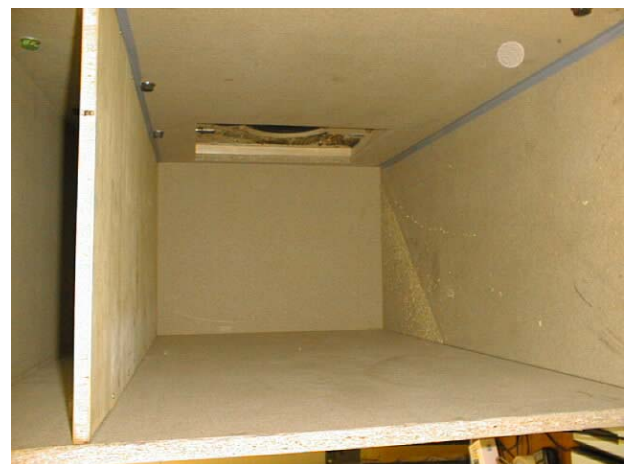
Bild E.6 Modell-Luftschacht leer (Querschnitt 600x800), mit Lautsprecher
