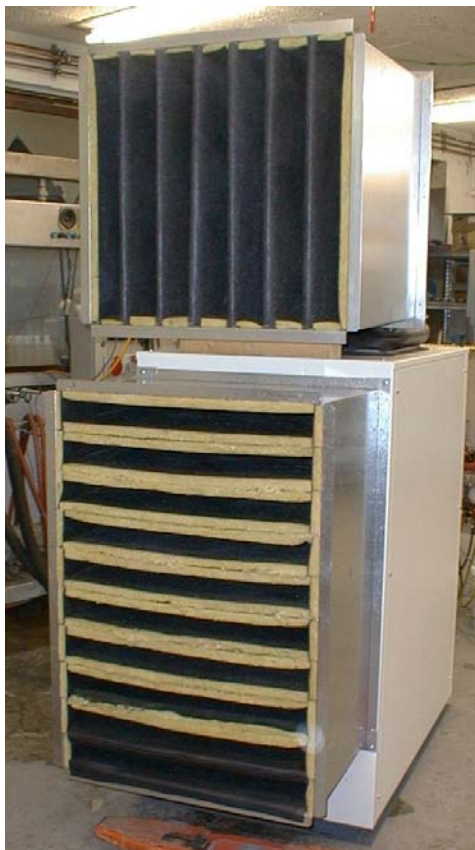
Bild E.3 Wärmepumpe mit Schalldämpfer
