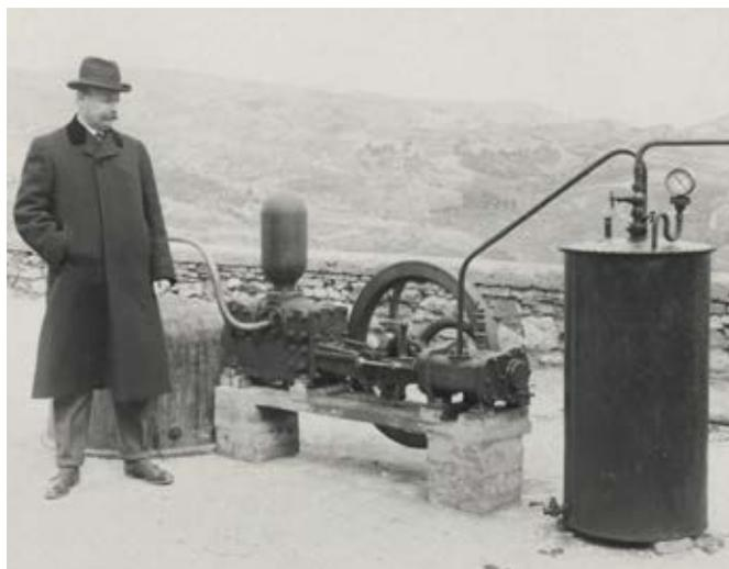
Larderello 1904: Eine mit geothermischem Dampf betriebene Turbine ist mit einem Dynamo verbunden und erzeugt, erstmals in der Geschichte, elektrische Energie aus Geothermie. Quelle: Enel Green Power - Geotermia
