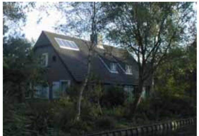
Abbildungen 57 und 58: **Die Umgebung muss bei der Planung unbedingt berücksichtigt werden.** Bäume wachsen... und dies beträchtlich während der Lebensdauer der Photovoltaikanlage von rund 25 Jahren. Eine schöne und abgestimmte Gestaltung des begrünten Raums berücksichtigt auch das Wachstumsmuster der verschiedenen Baumarten durchs Jahr (z.B. Laub- und Nadelbäume) und über die Jahre. Die abgebildeten Beispiele sind nicht nachahmenswert. Quelle: ECN, Niederlande
