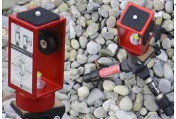
Abbildungen 59 und 60: **Verschattungshorizont.** Der verschattungsrelevante Horizont kann beispielsweise mit dem Instrument „horizon“ erfasst und mittels Solarplanungssoftware ausgewertet werden. Quelle: energiebüro Zürich
