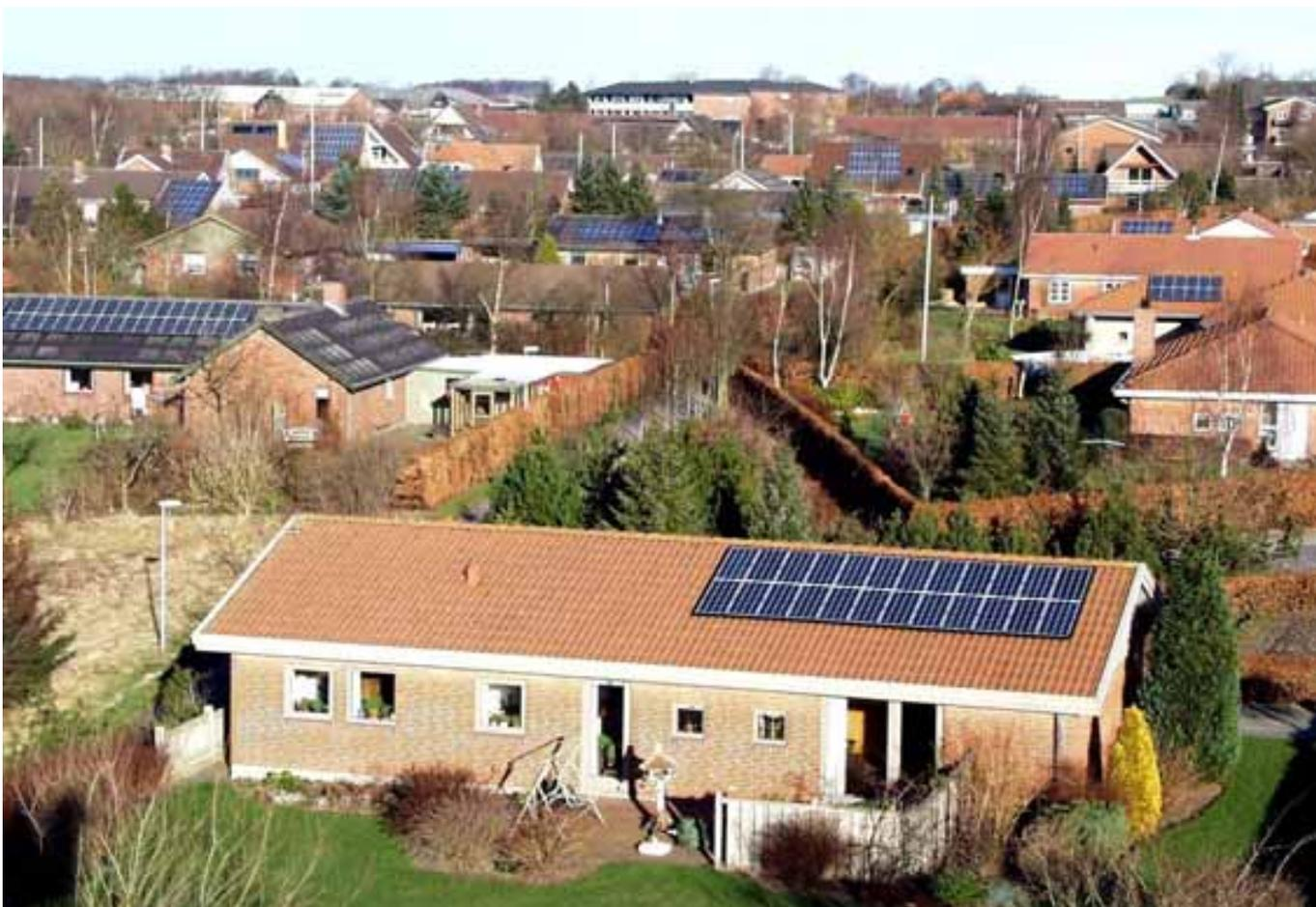
Abbildung 63: **Standardanlagen für Wohnhäuser in Braedstrup (Jütland, Dänemark).** Das Solarprogramm SOL300 umfasste die Installation von 300 Solaranlagen auf Wohngebäuden. Der Fokus ist einerseits auf standardisierte Anlagen und andererseits auf bereits bestehende Gebäude. Inzwischen laufen Folgeprogramme (SOL1000, etc.). Quelle: Energimidt Danmark
