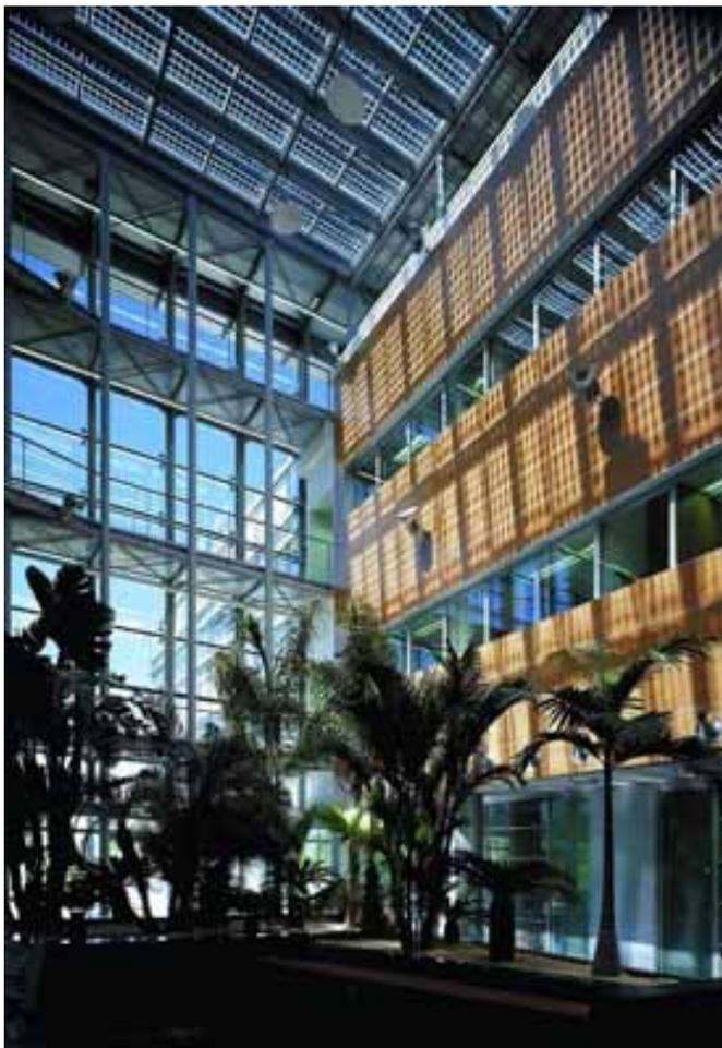
Abbildung 39: **Lichtdurchflutete Halle bei STMicroelectronics in Plan-les-Ouates (GE).** Die semitransparente Photovoltaikanlage erzeugt Solarstrom und ein angenehmes Ambiente. Quelle: AMA Group / Engeco Synergies, Italien
